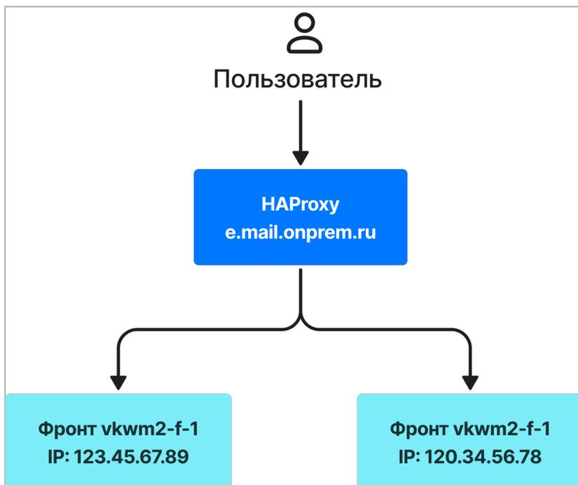
Ниже вы найдете [пример конфигурационного файла](#). Этот пример можно взять за основу конфигурации под вашу инсталляцию. В конфигурационном файле объявляются IP-адреса backend'ов, с которыми будет взаимодействовать HAProxy:
